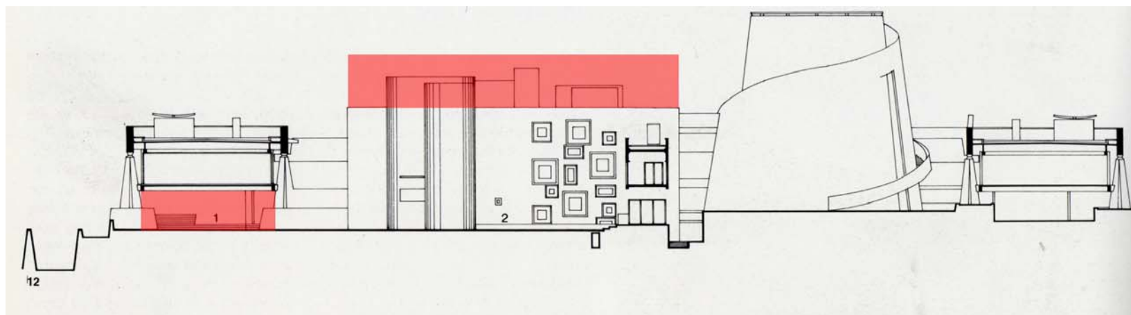
6 En el corte se gráfica zona ampliada de primer nivel y zona ampliada sobre azotea de núcleo central, vistas desde jardines centrales a ampliación sobre núcleo central, se aprecia la esquina de la sala de reuniones sin protección solar.
